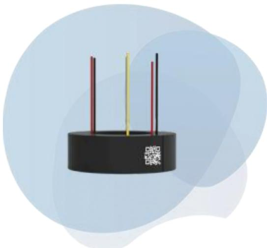
中科原子环状自动门控高压电源用于像增强器供电。利用微处理器MCU采样荧光屏输出亮度信号，控制阴极输出脉冲的占空比，结合MCP两端的电压控制，实现了像增强器在大动态范围下工作。相对传统普通的高压电源，选通状态下的像增强器动态范围更大，间歇式供电可有效延长像增强器的使用寿命。
